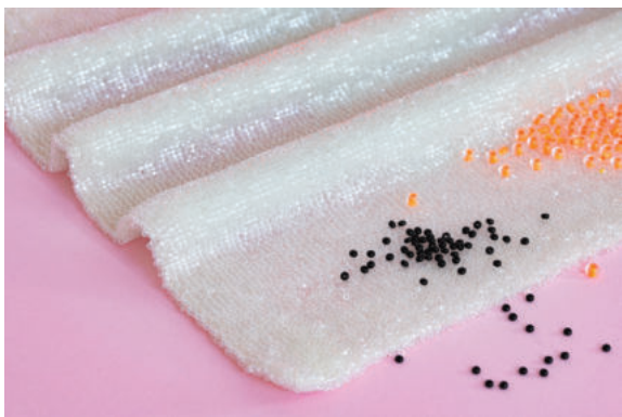
Obr. 6: Vzorek digitálně našívané skleněné perličky na textilní metráž za použití technologie firmy ZSK, realizace tým UMPRUM. Foto: Jakub Přecechtěl
