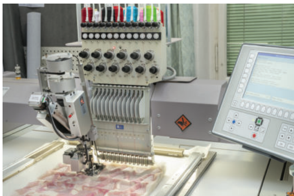
Obr. 14: Stroj na digitální našívání perliček firmy ZSK, realizace tým UMPRUM. Foto: Jakub Přecechtěl
