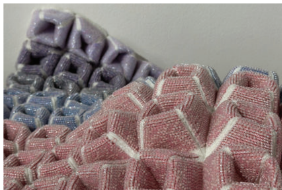
Obr. 15: Prostorové struktury tvořené digitálním našíváním perličky na textil za použití technologie ZSK. Realizace tým UMPRUM. Foto: archiv autorů
